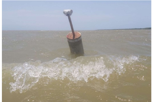
Figura 1. Pruebas de estabilidad y flotabilidad de concretos ligeros para cimentaciones flotantes de turbinas eólicas marinas. Fuente: proyecto IMP-ING-3121.
